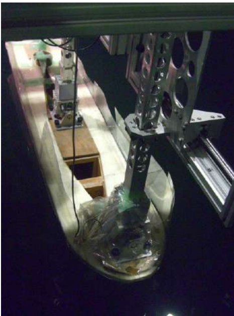
Gambar 4.6 Load cell terhubung ke model kapal
