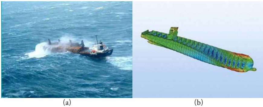
Gambar 1.3 a). Efek hidroelastisitas yang dialami oleh kapal di kondisi lautan; b). Hasil komputasi terkait hidroelastisitas kapal
