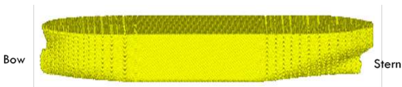
Gambar 7.20 Distribusi partikel SPH merepresentasikan model kapal tanker
