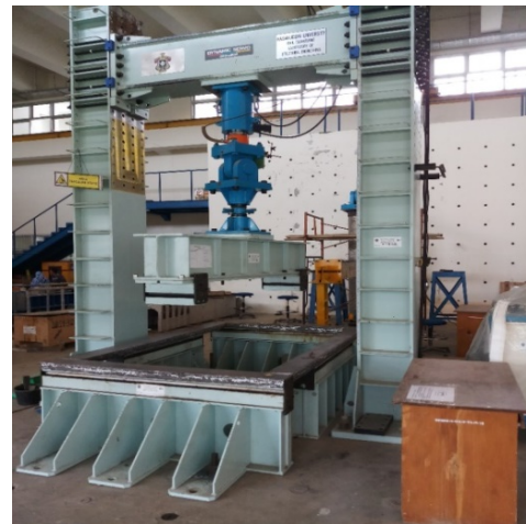
Gambar 7. Setting sendi dan frame load
