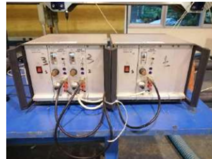
Gambar 5. Wave Monitor yang terhubung dengan komputer
