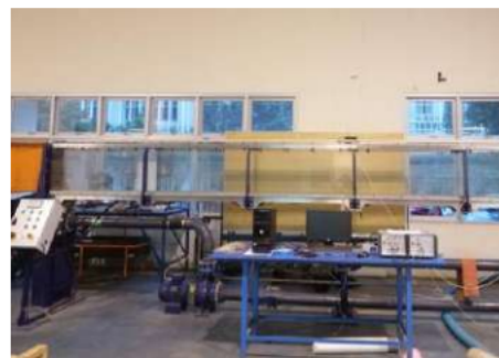
Gambar 2. Wave Flume pada Laboratorium Teknik Pantai Universitas Hasanuddin
