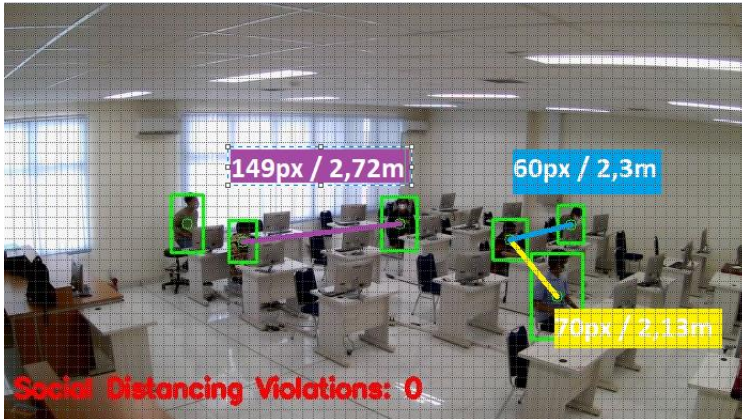
Gambar 8.12 Hasil Perbandingan jarak satuan pixel dan meter gambar ke-2 (Gambar Pribadi)
