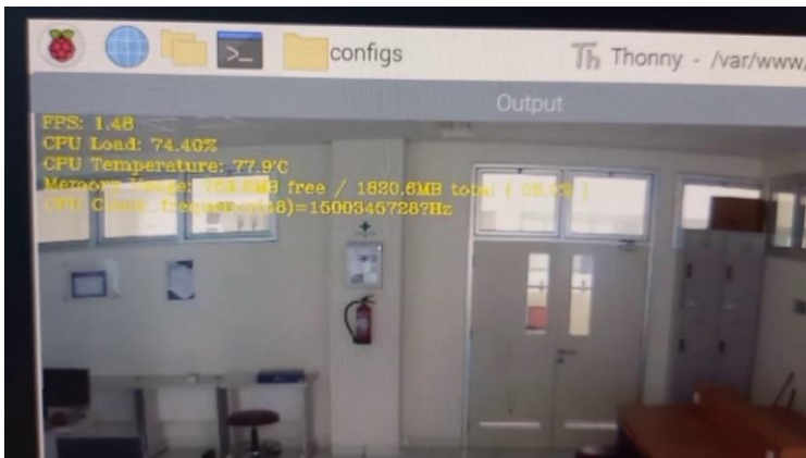
Gambar 8.26 Utilisasi CPU Raspi menggunakan algoritma YoLov3-tiny (Gambar Pribadi)
