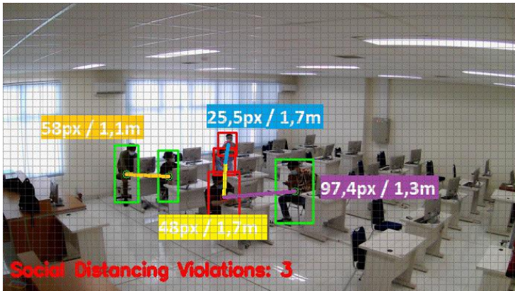
Gambar 8.7 Perbandingan jarak satuan pixel dan meter (Gambar Pribadi)
