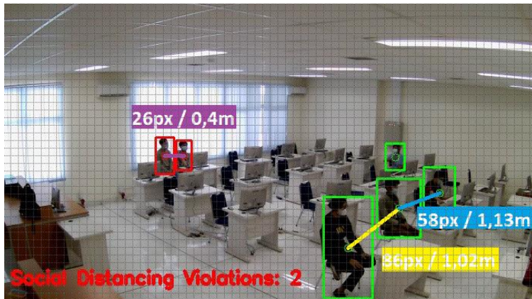
Gambar 8.15 Hasil Perbandingan jarak satuan pixel dan meter gambar ke-5 (Gambar Pribadi)
