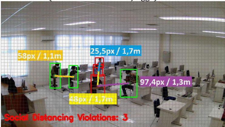
Gambar 8.11 Hasil Perbandingan jarak satuan pixel dan meter gambar ke-1 (Gambar Pribadi)
