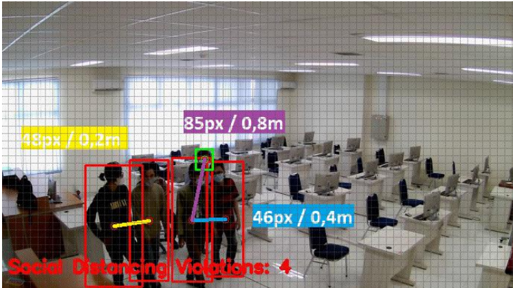
Gambar 8.16 Hasil Perbandingan jarak satuan pixel dan meter gambar ke-6 (Gambar Pribadi)
