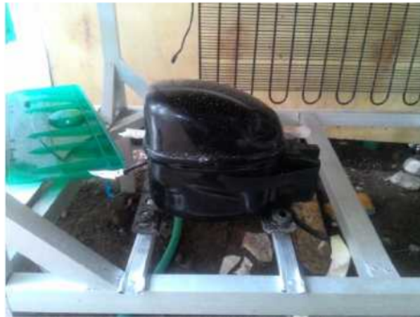
Gambar 3. Hasil Sistem Pendingin Penampungan Air dengan kondensor
