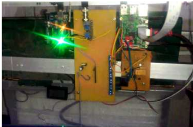
Gambar 2. Rangkaian Sensor Untuk Mendeteksi kualitas Air
