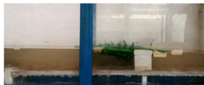
Gambar 6 Tampak samping penumpukan aliran debris pada flume
