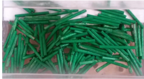
Gambar 7 Tampak atas penumpukan aliran debris pada flume
